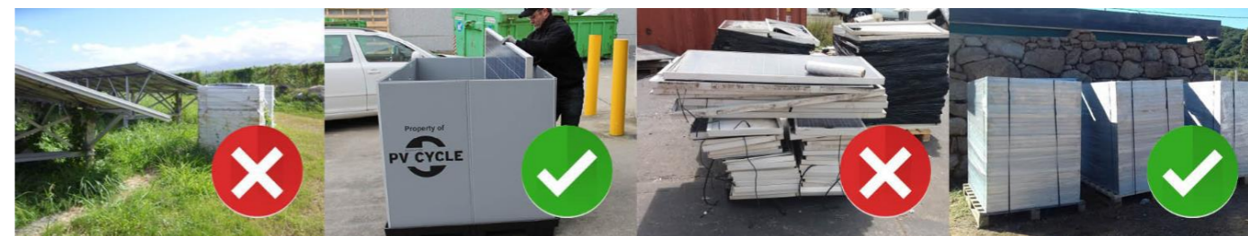
Illustration 30 : Conditionnement des palettes de panneaux photovoltaïques usagés
